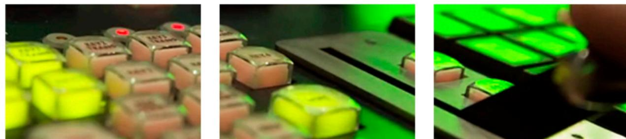
O Switcher máster é o coração da televisão, através dele é selecionado o sinal de vídeo que será visto pelo Telespectador. A mesa de controle mestre digital TV Switcher é um comutador com 10 canais de entradas SDI/IP híbridas, configuráveis e comutáveis e conta com 24 máscaras de transição. Através dele é possível capturar/gravar sinais de vídeo e inserir gráficos e caracteres. Operação intuitiva, credibilidade, software em português, segurança e estabilidade são algumas de suas características.
